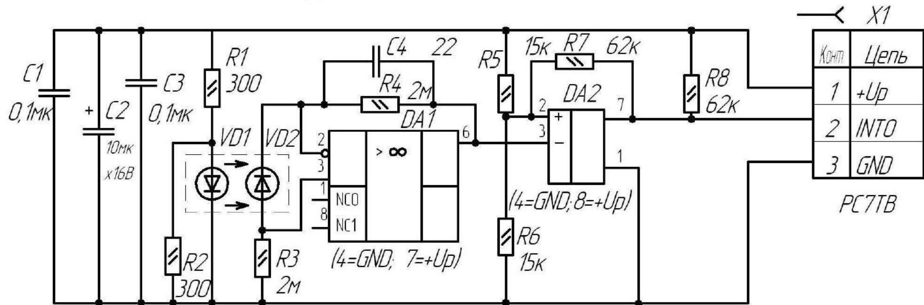
Рисунок А2 – Датчик ветра. Схема электрическая принципиальная
